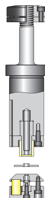
上向バーリング 下穴別工程型
