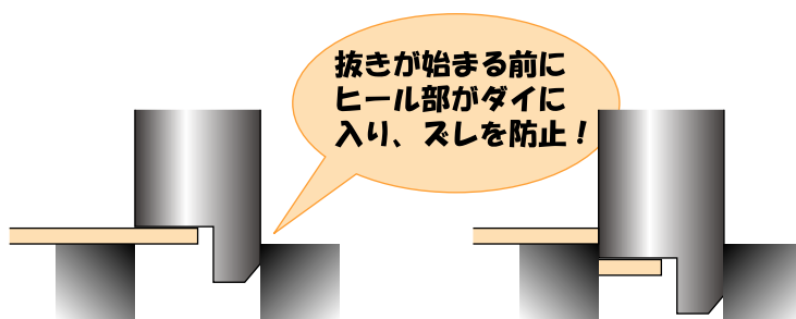
図3 ヒール付金型によるパンチのズレ防止
