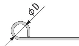
ワーク端面の一部をカールさせてヒンジを作る加工です。
