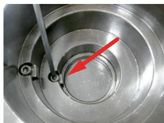
①2"用パンチ組み治具キー(画像の位置)をM6用の六角レンチで外します。
