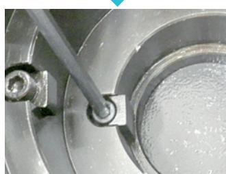
②同梱のキーを組込み、M6用の六角レンチで締付けしてください。
