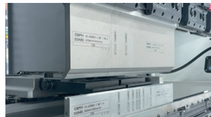
ベンディング機にセットされた CEFH 金型
