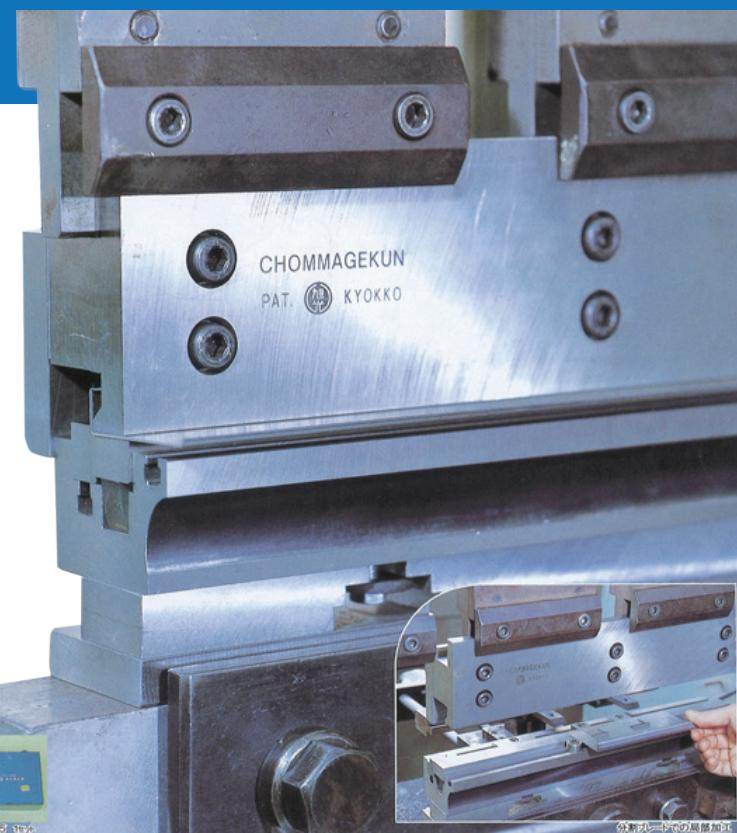
加工板厚の変更時は、製品と同じ厚さのシムに交換するだけで曲げ設定が簡単にできます！
