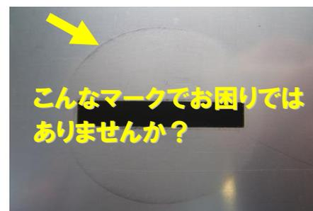
**金型によるワーク表面への“押えマーク”を低減し、板金品質を改善します。**
