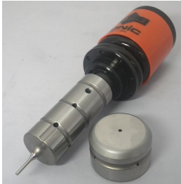
今回テストで使用した金型 PROTECH3 1-1/4" 標準丸形状セットφ3.3 C=0.3
