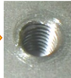
バーリング加工なしで直接タップ加工
