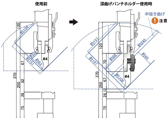
**注意** 干渉する中間板を外して行う中抜き曲げは、曲げ長さや使用金型によりワークの中央が甘く曲がる場合があります。
