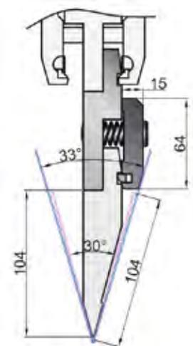
30°の曲げはワークが干渉します。加工製品の不良等为了避免のため、干渉しない範囲で曲げて下さい。
