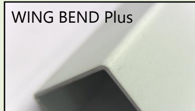
曲げ比較写真 加工材:SECC T=1.6
