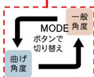
曲げ角度モード・・・ワークに装着したままリアルタイムで、両側曲げ角度を表示
