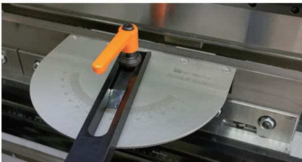
③ ガイドバーの目盛線を任意の角度に合わせて、ワークをガイドバーに当てて加工を開始します。
