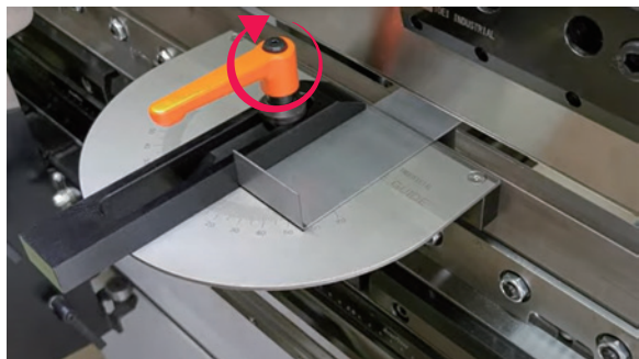
② プラスチックハンマーで本体のフロントテーブルとダイ上面の位置が合う様に調整します。
