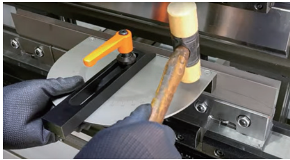
② プラスチックハンマーで本体のフロントテーブルとダイ上面の位置が合う様に調整します。
