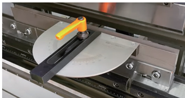
① ダイと本体をマグネットで密着させます。
