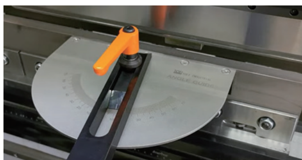
③ ガイドバーの目盛線を任意の角度に合わせて、ワークをガイドバーに当てて加工を開始します。
