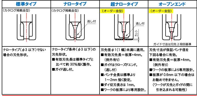
ガイドクリアランスを狭くし、刃先を抱き込む事でパンチボディのブレの防止、刃先研磨しろを無くし可能な限り刃長を短くする事で強度を高めた対策をはじめ、特殊な仕様も製作できます。
